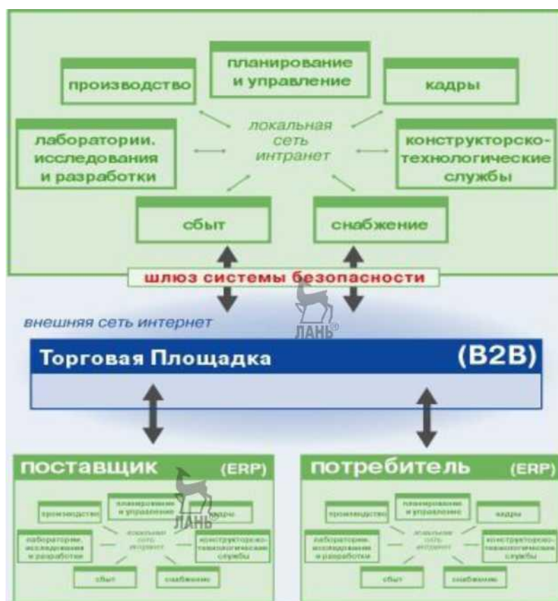
Рис. 1.4 - Схема интеграции ERP-систем поставщиков и потребителей посредством B2B- систем электронного бизнеса
